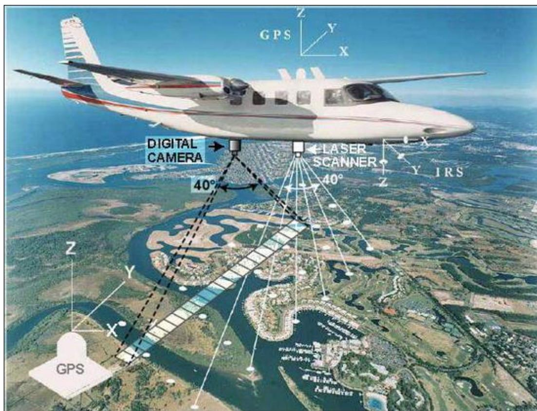
FIGURA 5. CONFIGURAZIONE DEL SISTEMA LIDAR
